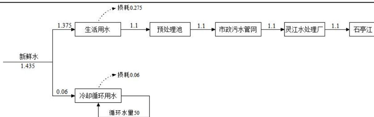
图 2.1 项目水平衡图  $m^3/d$
