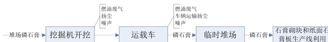
图 2-1 堆场磷石膏转运流程及产污环节
