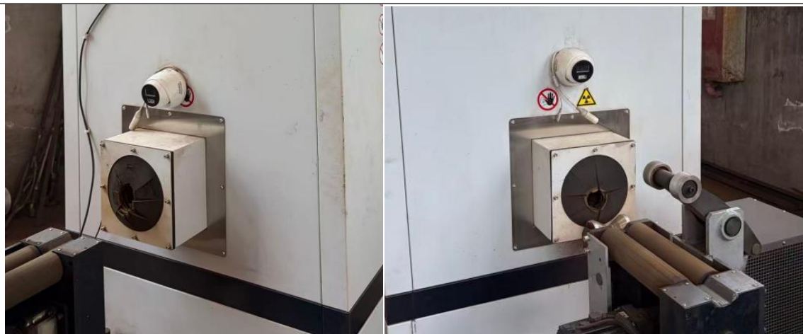
工件进出口出铅橡胶防护设施
