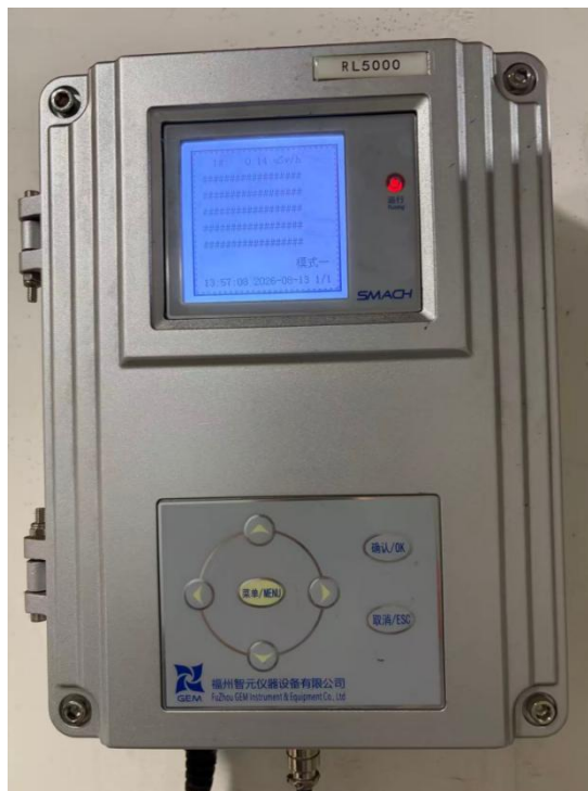
固定式场所辐射探测报警装置
